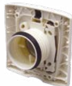
Figura 4: Hay ranuras de sellado detrás de la toma de aspiración, que pueden acortarse si es necesario en función del grosor del material de la pared. Si el material de la pared es más grueso, es posible utilizar una extensión separada entre el soporte de montaje y el conjunto de la cubierta.
