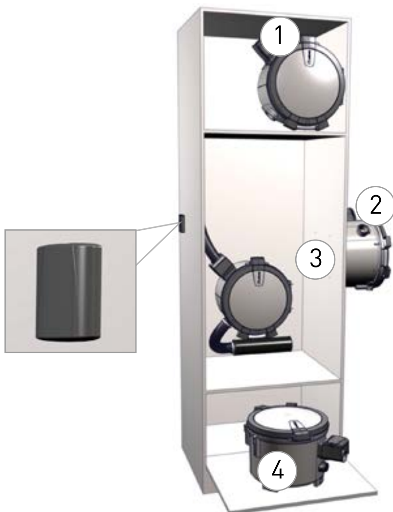
Figura 13: Si el aparato se instala en un armario, recomendamos que la toma de aspiración se coloque fuera del armario para que la puerta del armario pueda cerrarse durante la aspiración.
