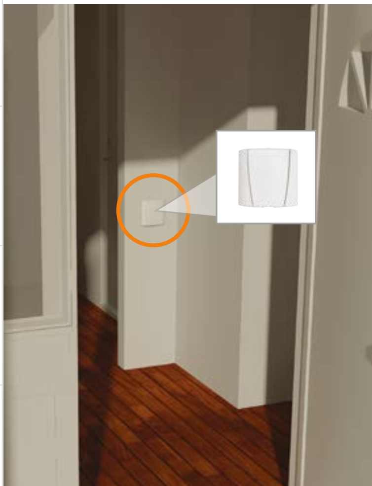
Figura 2: Recomendamos que las tomas de pared estén instaladas al mismo nivel que los enchufes o los interruptores de luz.
