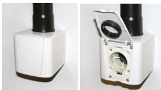
Figura 11: La caja para instalación en superficie (accesorio) se utiliza en la instalación superficie de la tubería. La caja para la instalación en superficie se monta en la pared. El acoplamiento del codo está unido a la tubería y la tubería es empujada hacia arriba hasta el ángulo agudo de 90° del acoplamiento del codo. La tubería se inserta en la caja. Los conductores de baja tensión se unen a la toma y esta se instala en la caja.
