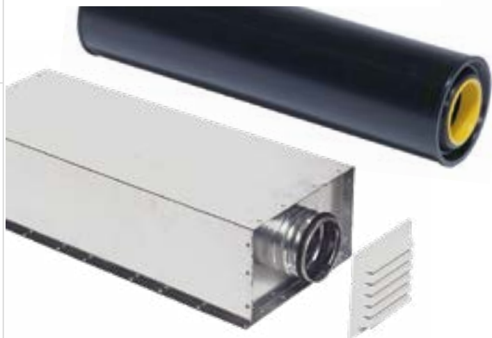
Figura 4: Allway tiene dos tipos de silenciador. Arriba se encuentra el silenciador básico que reduce el ruido en aproximadamente 14LpA (dB). Debajo está el silenciador turbo que reduce el ruido en aproximadamente 20LpA (dB).
