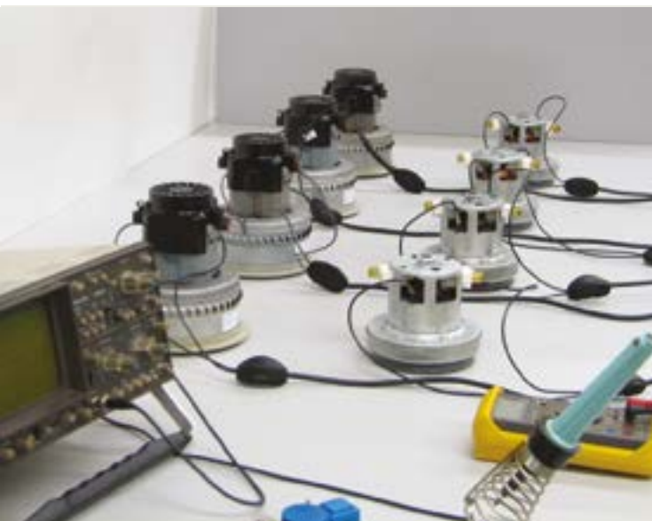
Figura 6: Las pruebas de tiempo de vida de las turbinas se llevan a cabo en los propios laboratorios de Allaway.
