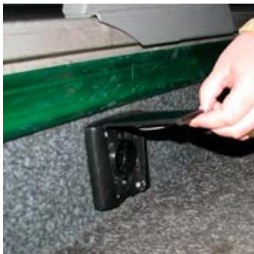
Figura 15: La unidad central Duo dispone de un soporte de pared seguro que permite diversas formas de instalar Duo. El soporte de pared garantiza que Duo quede firmemente sujeto a la pared. Duo también puede instalarse desde la parte inferior hasta la estantería sin soporte de pared ( cuadro 3).
