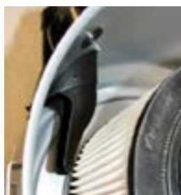
Figura 4: El deflector de aire desvía el flujo de aire lejos del filtro, lo que aumenta su vida útil.
