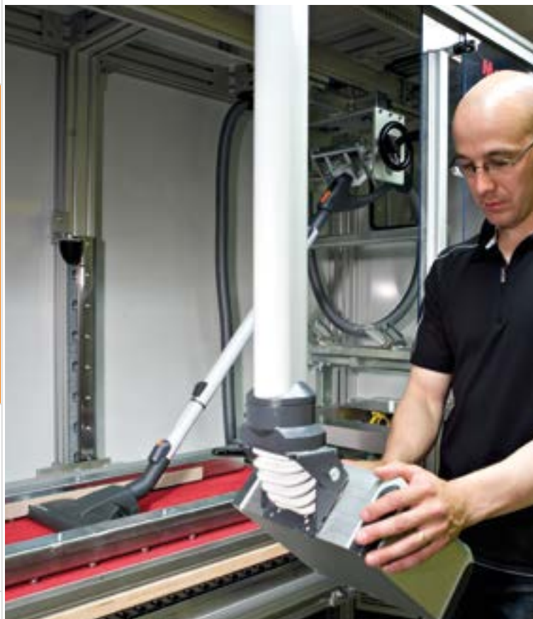
Figura 8: Se realizan ensayos de recogida de polvo para probar la capacidad de eliminación de polvo de los diferentes tipos de boquillas en diferentes tipos de superficies, por ejemplo en suelos duros o en una gama de alfombras diferentes.
