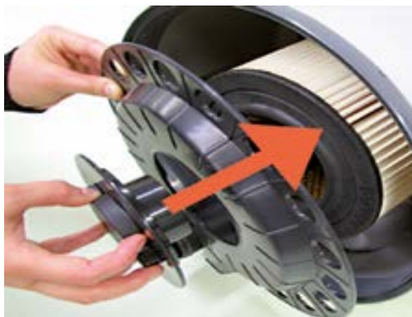
Figura 6: Con la ayuda del kit de instalación, la bolsa recogepolvo se instala fácilmente en la carcasa central de la unidad central. No se necesitan herramientas específicas para la instalación. El kit de instalación puede insertarse o retirarse de la máquina en cualquier momento.
