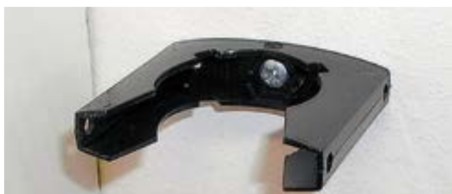
Figura 5: Abrazadera de tubo fijada con un tornillo en el centro. Este método de instalación también permite que la tubería se mueva en la dirección longitudinal, por ejemplo, durante la dilatación térmica.
