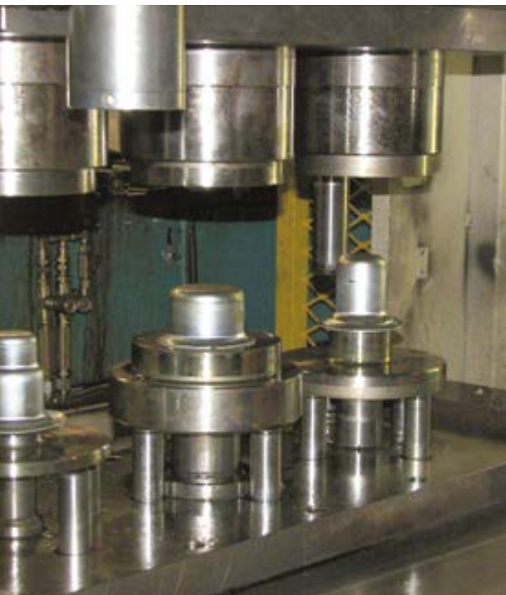
Figura 1: La técnica de embutición profunda asegura que las unidades centrales Allway son herméticas y sin fisuras.
