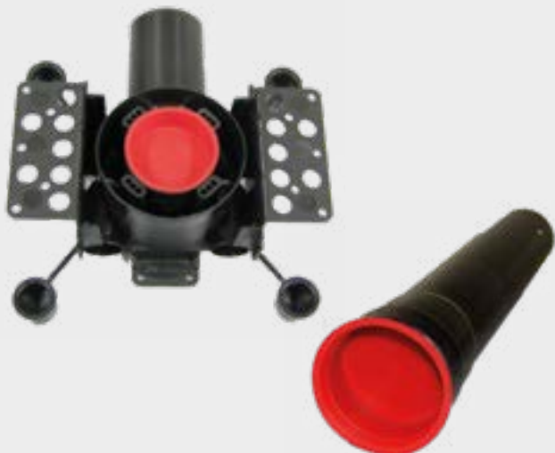
Figura 7: La estanqueidad al aire se comprueba cerrando todas las tomas de pared o soportes de montaje usando tapones de tubo (DPI-66 y DPI-70)
